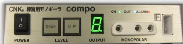
起動直後全ランプ点灯
